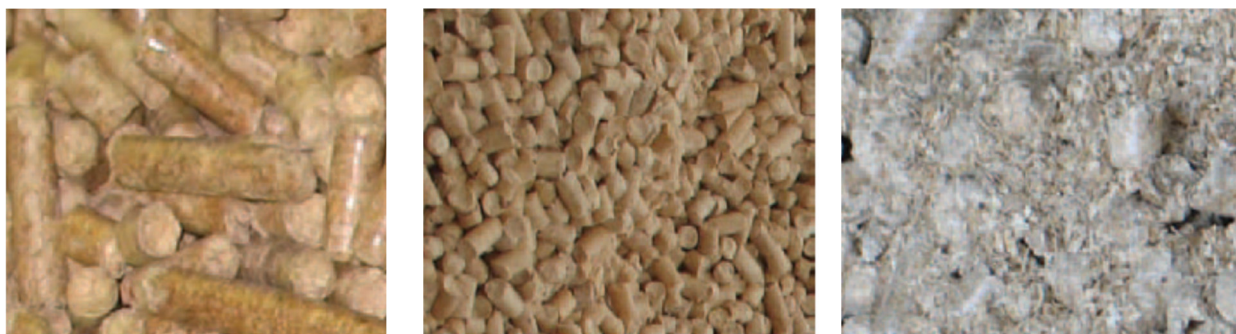
Fig. 3.10.2. Calitatea peletelor: bună (stânga); medie (centru); slabă (dreapta) [21]
