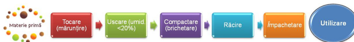
Fig. 3.6.3.1. - Procesul tehnologic general de brichetare [18]
